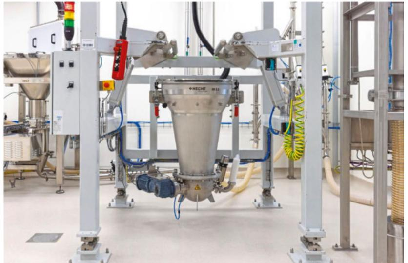
Der PCC700 wurde speziell für die Verbindung von wertschöpfenden Maschinen wie Mixern und Abfüllanlagen mit hohen Produktionsvolumen entwickelt
