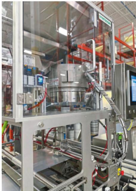
Seit der Integration des CVA 2000 VIS Internal Valve Applicator von Syntegon ist Rootrees Produktionslinie vollständig automatisiert und erzielt eine deutlich höhere Ausbringung
