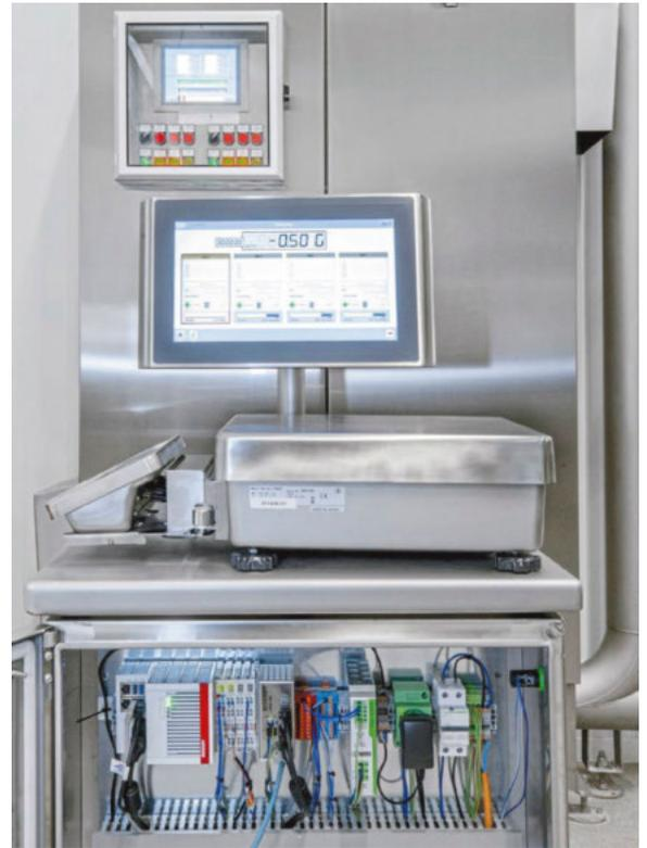
Twincat sowie ein Embedded-PC CX5240 (unten) und ein Edelstahl-Control-Panel CP3916 (Mitte) erleichtern die Integration der Daten aller möglichen Systeme, wie z. B. dieser Standwaage, und bilden deswegen das Rückgrat einer cloudbasierten Lösung
