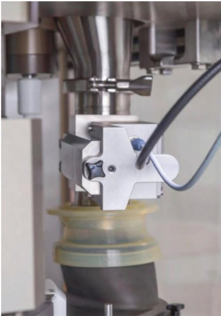
Beispielhafter ePAT-Messkopf (integrierter Nahinfrarotsensor im Füllrohr einer Rundläufertablettenpresse)
