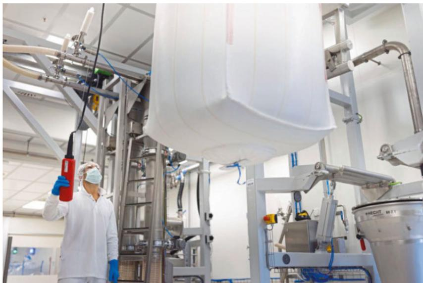
Über einen Laufbahnträger mit Kettenzug sowie ein Ladegeschirr lassen sich die Big Bags sicher anheben und über dem Anschlussystem zum Entleeren positionieren
